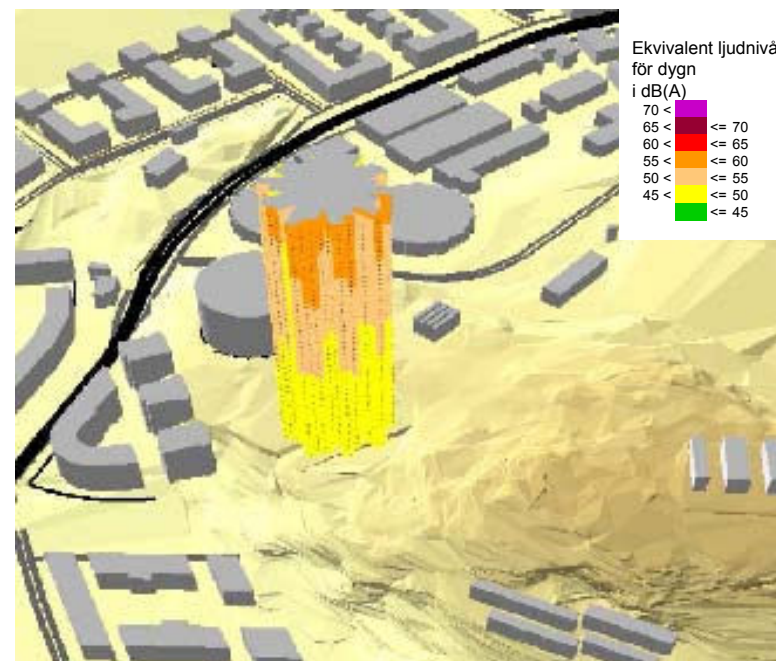
Ekvivalent ljudnivå vid fasad för den planerade byggnaden på platsen för gasklocka 4. [21]
